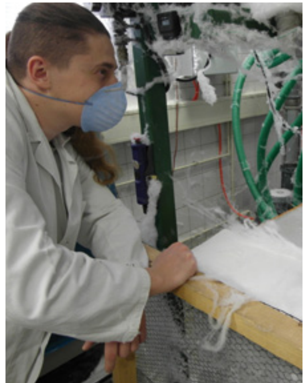
Vlies aus Melamin-Formaldehyd-Harzen: TITK-Mitarbeiter Sven Heinemann an der kleintechnischen Versuchsanlage in Rudolstadt-Schwarza
