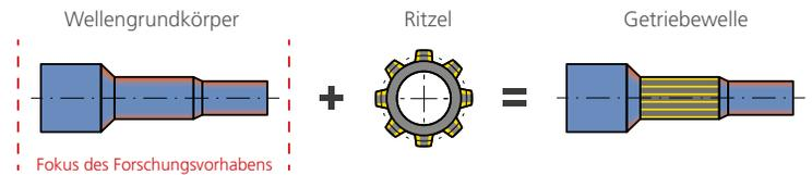
Schematische Darstellung der Herstellung einer gebauten Getriebewelle durch Fügen eines Wellengrundkörpers und eines Ritzels
