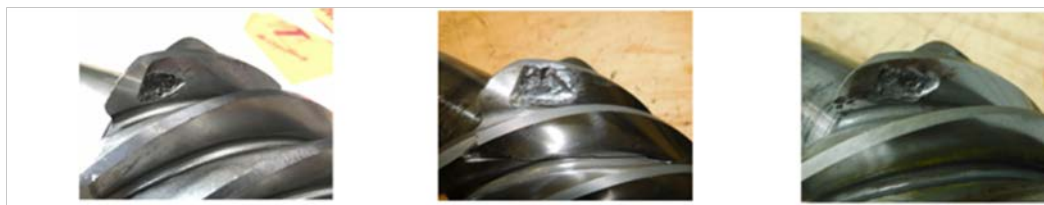
Schadensbilder bei entsprechender Laufzeit bis zum Ausfall durch Grübchen
