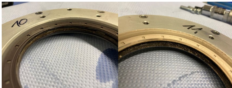
Abbildung 1: RWDR nach einem Prüflauf (links ohne Schmutzbeaufschlagung, rechts mit Schmutzbeaufschlagung)
