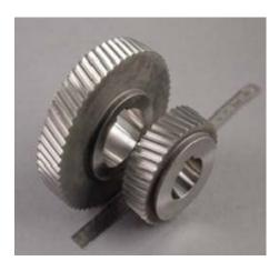
Durch innovative Verzahnungen kann die Gleitreibung im Getriebe deutlich vermindert werden.
