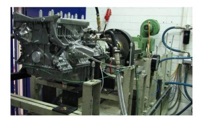
Um den Einfluss der Gleitlager auf die Gesamtreibung im Motor nachweisen zu können, wurde eine Vielzahl von Prüfstandsversuchen durchgeführt.
