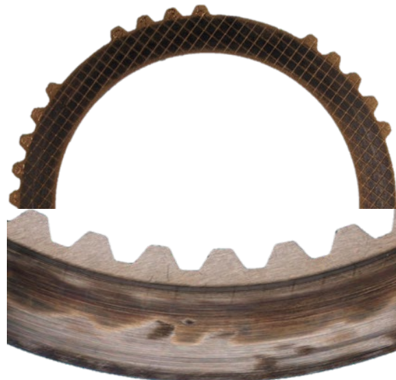
Abbildung 2: Exemplarische Schadensbilder von Sinterübertrag der Reibpaarung Stahl / Sinter
