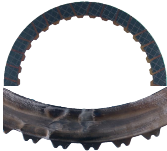
Abbildung 3: Exemplarische Schadensbilder von Hot Spots der Reibpaarung Stahl / Papier
