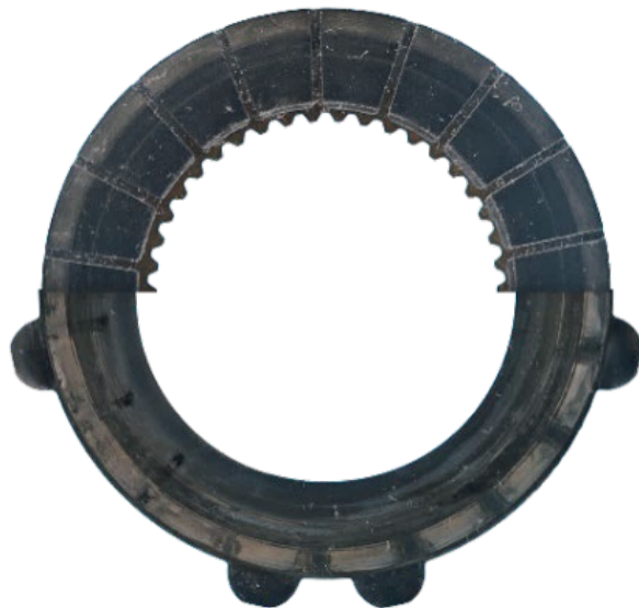
Abbildung 4: Exemplarische Schadensbilder der Reibpaarung Stahl / Carbon
