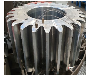
Temperaturmessung bei der Einsatzhärtung eines Modul 18 mm Zahnrads.
