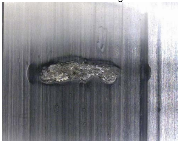
Bild: Pittingschaden aufgrund Überlasten
