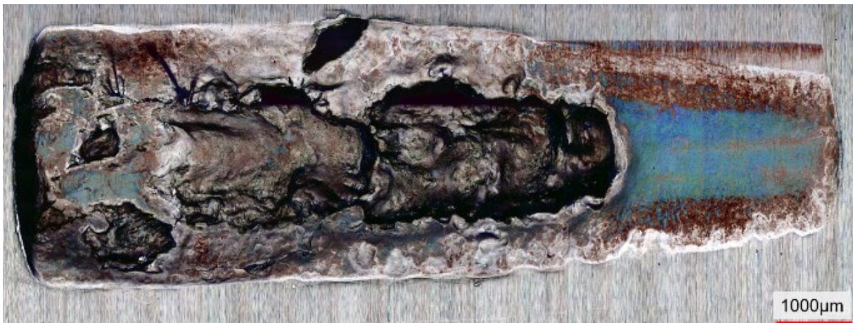
Bild 1: Ausbruch am Innenring eines Versuchslagers.
