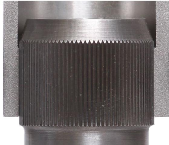
Aufgeschnittene dünnwandige ( $Q_A = 0,8$ ) Rändelpressverbindung mit 30 mm Wellendurchmesser und einer Fügelänge von 15 mm. Welle aus 16MnCr5, Nabe aus EN AW-5083. Rändelung wälzgefräst.
