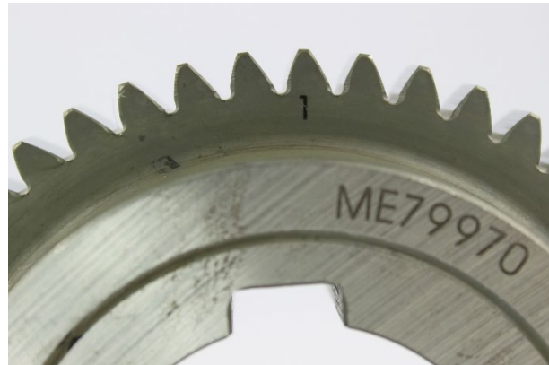
Asymmetrisches Zahnrad mit unterschiedlichem Eingriffswinkel an Links- und Rechtsflanke
