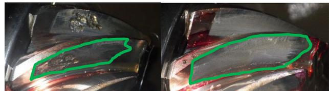
**Bild 1: Kegelritzelzahn bei treibendem Kegelritzel nach 3 Mio. Lastwechseln (links) und bei treibendem Tellerrad nach 19 Mio. LW (rechts), markiert ist die aktive Flanke**
