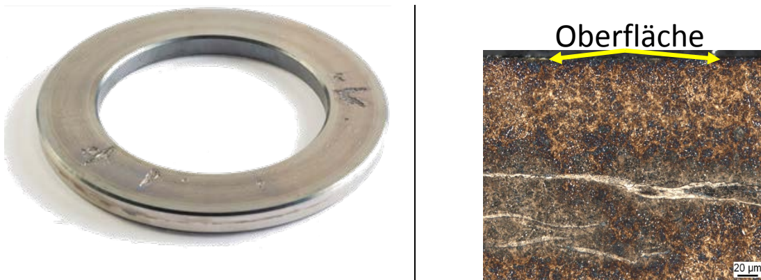
Abbildung 1: Schadensbild an einem Lagerring (links); Schliffbild eines Rissnetzwerks (rechts) nach Nital anätzung
