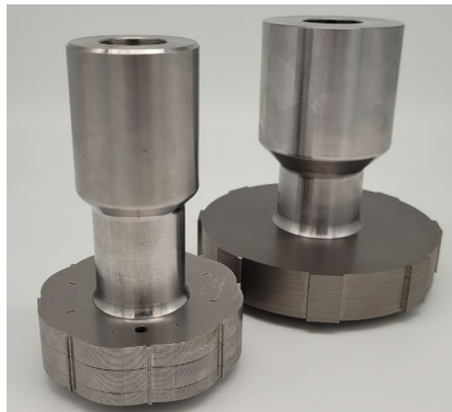
Abbildung 1: Vergleich stanzpaketiertes (links) vs. verbackenes Blechpaket (rechts) in Pressverbänden mit hohem Übermaß
