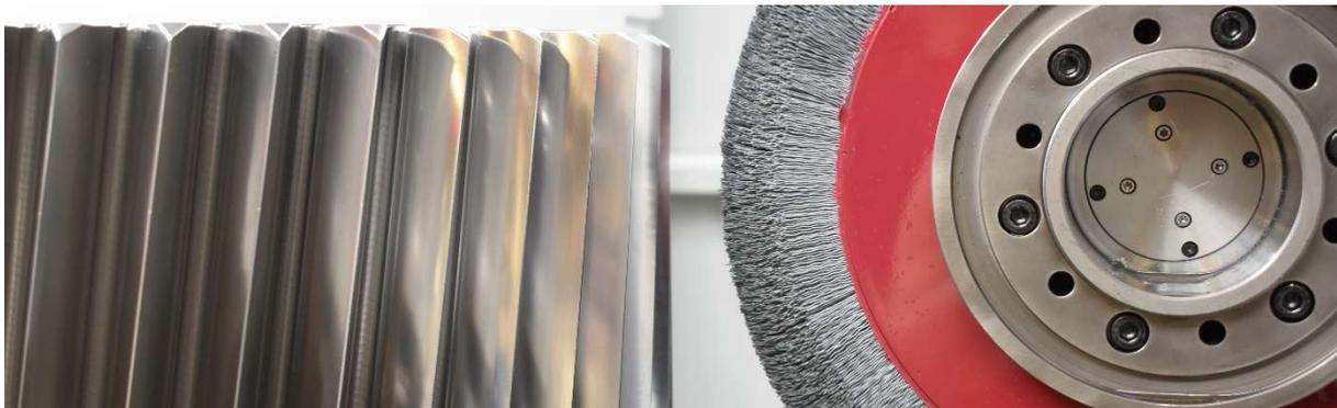
Bild: Gebürstetes Referenzzahnrad ( $z = 39$ ,  $m_n = 10$  mm,  $b = 200$  mm) und abrasives Bürstwerkzeug
